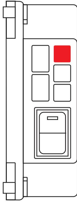
Место ввода кабеля управления электрическим насосом.
