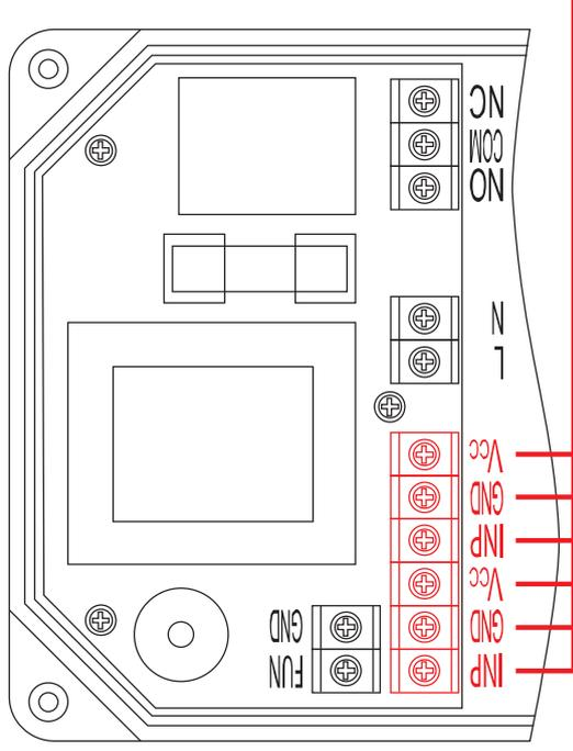
Клеммы для подключения датчиков протечки воды:
