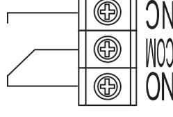
**Внимание.** Нагрузочная способность реле управления:  $I_{max}=10\text{ A}$ ,  $U_{max}=250\text{ В}$ .
