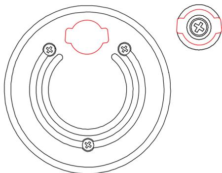
На корпусе крепежного элемента есть специальные выступы для фиксации радио датчика. При монтаже эти выступы должны совпасть с соответствующими прорезями в плате радио датчика. Для отсоединения радио датчика от крепежного элемента нужно легко потянуть вверх радио датчик, и постепенно вращая радио датчик найти положение, при котором радио датчик можно отсоединить от крепежного элемента.
