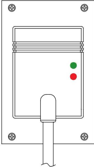
Устанавливать блок радио приемника нужно в местах с устойчивой радиосвязью, удобных для обслуживания и визуального контроля состояния световой сигнализации.
